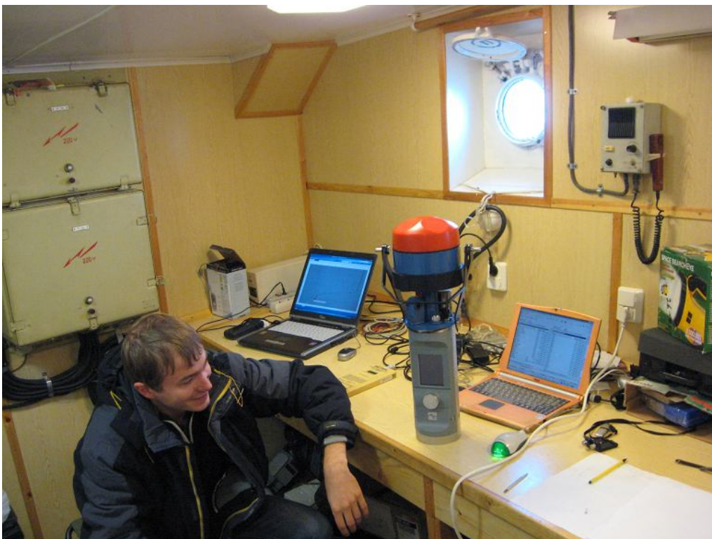
Установка режима работы доплеровского профилографа течений RDCP600 перед измерениями. Снс кфмн Будников А.А. в судовой лаборатории.
